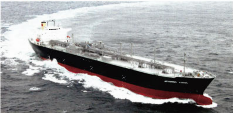
【船概要について】 ①要目:全長 230m、幅 36.6m、深さ(船底から甲板までの高さ)21.65m ②船種:LPG 運搬船(液化石油ガス運搬船) ③タンク容積:約 83,000 m 3 ④総トン数:約 48,300トン
